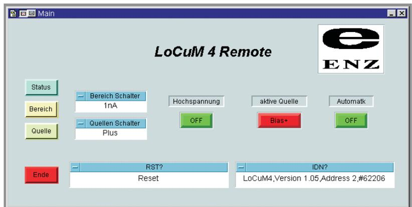
tronenspeicherring oder in angeschlossenen Experimenten – sogenannten Beamlines. Dort müssen vierkanalig Ströme vom Picoampere-Bereich bis max. 1 mA erfasst werden. Hinzu kommt, dass diese Messgrößen physikalisch bedingt auch noch auf einem Potential liegen können, das mehrere hundert Volt vom Erd-Potential entfernt ist (BIAS-Spannung).
